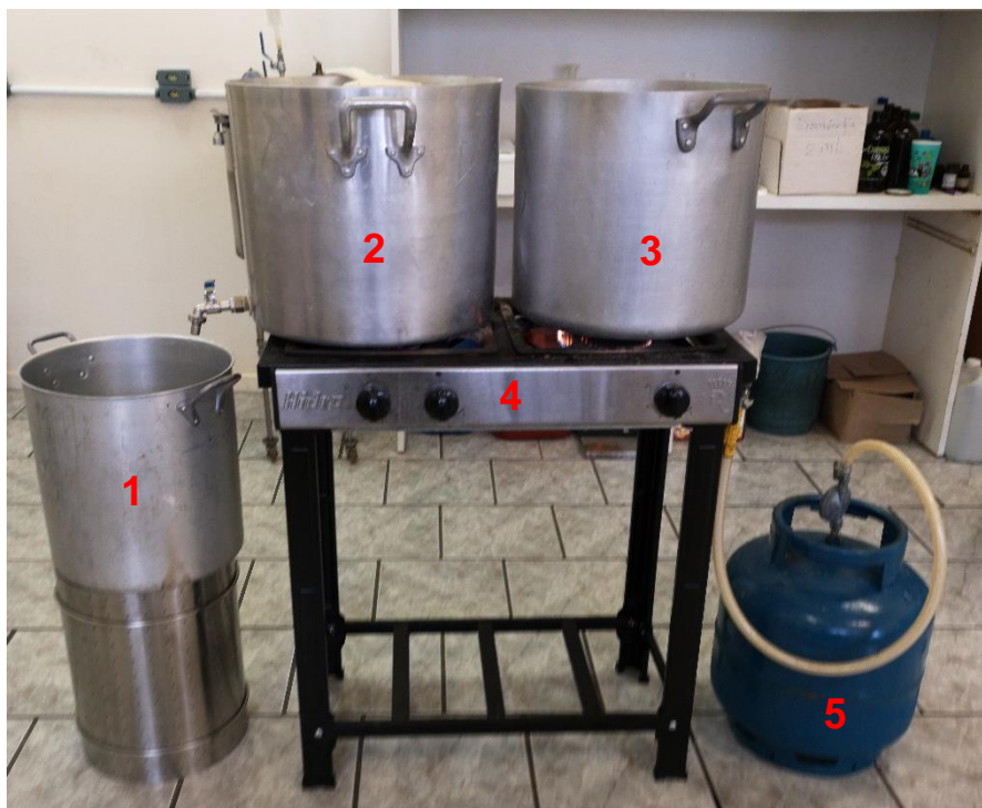
Figura 1-Sistema de três painéis para a produção do mosto. Legenda: 1-Panela de fervura; 2-Panela de brassagem; 3-Panela de água 70 °C; 4-Fonte de calor (fogão a gás); 5-Botija de gás propano.
