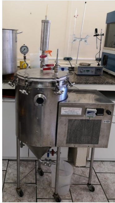
Figura 2-Fermentador de inox 50 L com controlo de temperatura (Novus N480D) (temperatura de operação 0 a 25 °C) utilizado para a fermentação primária.
